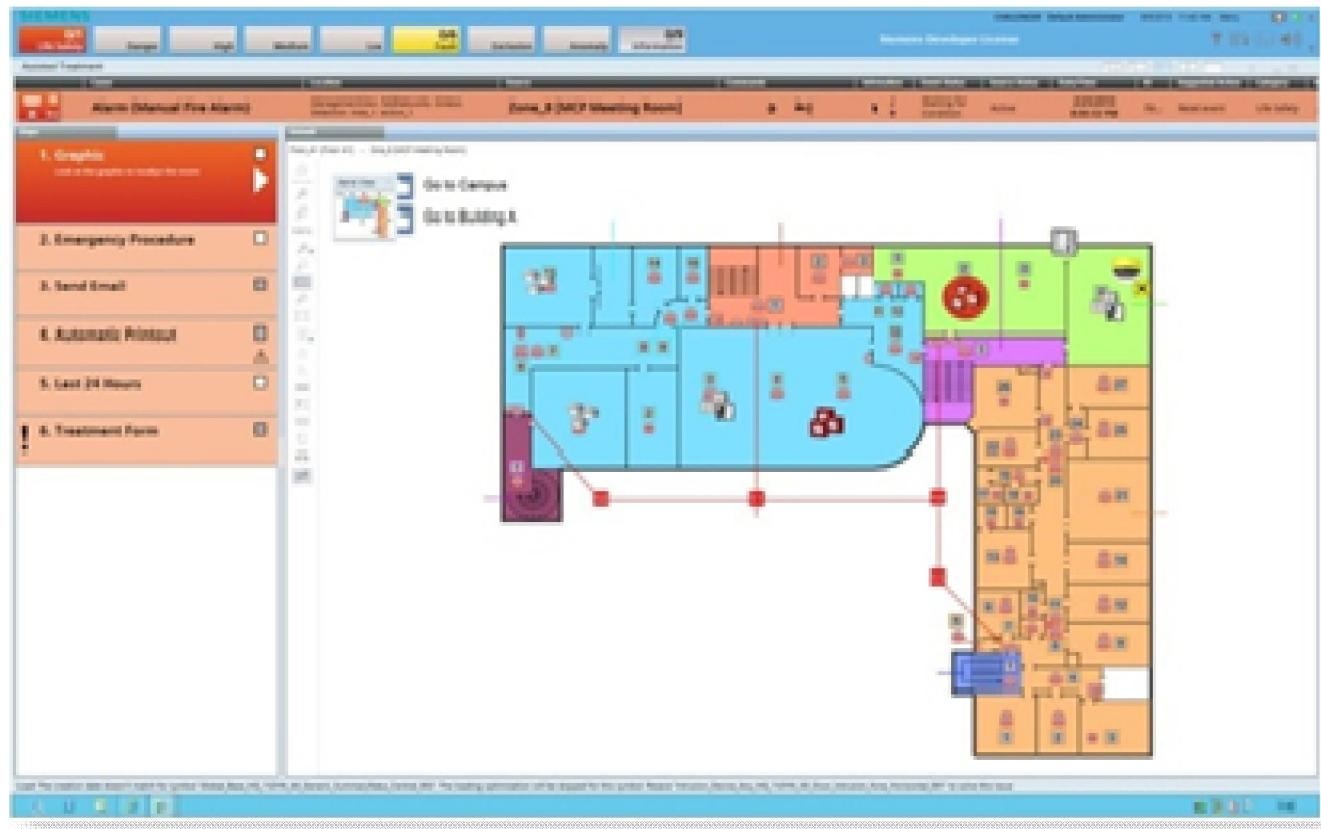
При использовании параметра “автоматический запуск” для процедуры обработки, в случае появления событий система автоматически отобразит на экране подробные сведения по событию, соответствующую графику и видеокамеры без необходимости дополнительных действий оператора
